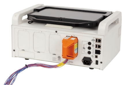
本体背面にSIMスロットをはじめ、恒温槽等のKaye製品、USB、ネットワークなどのポートを装備
